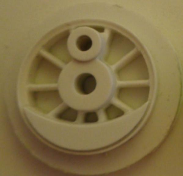
Abgeformte Urform aus Silikon
