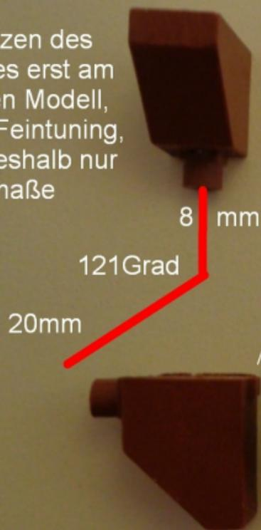
Diese kleine quadratische Erhebung passt in eine entsprechende Öffnung in der Karosserie-Grundplatte, die genaue Lage der Sandkästen ist damit vorgegeben. Die Sandleitungen zum Rad setzt man erst an der fertigen Lok, wenn die Leitungen händisch gebogen und angepasst sind, ein.
