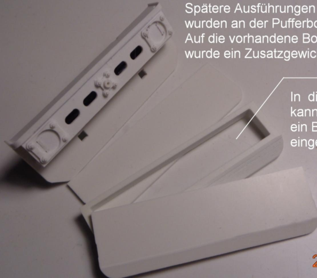
Spätere Ausführungen der MAK240B wurden an der Pufferbohle beschwert. Auf die vorhandene Bohle/Schürze wurde ein Zusatzgewicht montiert.
